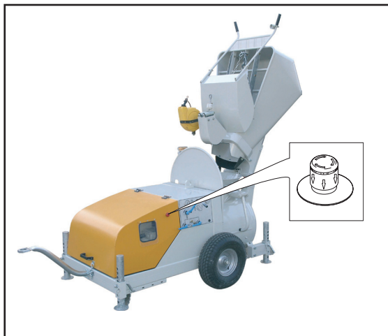
Кнопка аварийного выключателя
